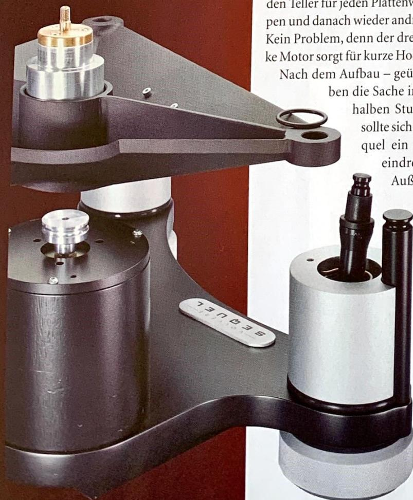
men den zirka fünf Kilogramm schweren Alu-Teller antreibt, dessen Resonanzneigung von einer Korkmatte beziehungsweise einem umlaufenden Gummiring effektiv unterdrückt wird. Seine Energie bezieht der 24-Pol-Läufer aus einem aufwändig gemachten externen Netzteil, das eigentlich eine 24-Volt-Mono-Endstufe ist, die quartzesteuert passende Frequenzen für 33,3 und 45 Umdrehungen pro Minute liefert.
