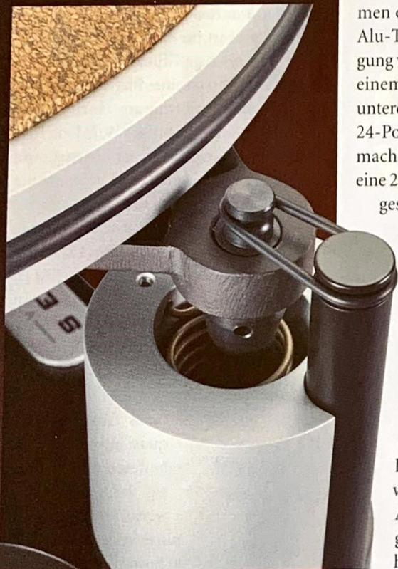
Das Subchassis aus Alu, das den Teller und den Tonarm trägt, stützt sich an drei Punkten auf ein Federbein ab, dessen Horizontalbewegungen ein kleiner Gummiring dämpft
